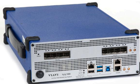
VIAVI Solutions Xgig 1000 是唯一一种具有可重新配置端口的综合便携式平台，用于 10 和 40 GE 及 4/8/16 G 光纤通道。凭借独特的便携式机箱，Xgig1000 支持在制造商研发实验室进行详细的协议测试，并帮助现场安装人员部署和排查 SAN。Xgig 1000 也是唯一一种可执行内联、非侵入式捕捉和分析、内联干扰及终端节点仿真的平台，可以 16 G 执行生成和负荷测试，以太网分析最高可达 40 G。Xgig 1000 可以配合专家视图 (Expert View) 获取存储性能分析信息，以便快速识别光纤通道和以太网中独特相关的问题。存储业的服务和支持专业人员依赖于 Xgig 跟踪捕捉格式。
