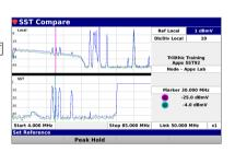
• 此功能用于确定 9581 SST 检测到的中断侵入是否来自 测试仪当前连接到的系统段
