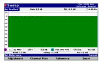
载波的频带上对分配网放大器的斜率和增益进行测试和 设置
