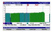
蓝色表示模拟频道,绿色表示 SC-QAM 数字频道,浅绿色表示 OFDM 数字频道
