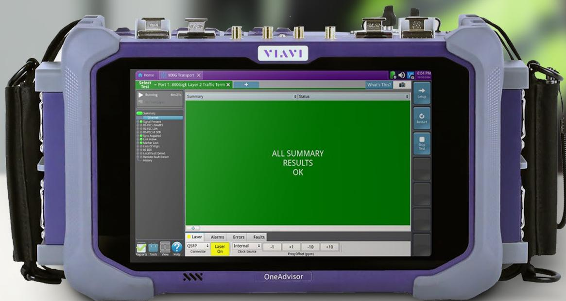
OneAdvisor 800 为技术人员和工程师提供安装和维护最高 800G 的高容量网络所需的所有测试功能。OneAdvisor 800 的便携性和模块化使其非常适合城域网/核心网、数据中心互连和商业服务测试。OneAdvisor 800 800G 传输模块支持高达 800GE 的测试，其用户界面与 MTS 系列中的所有模块相同。
