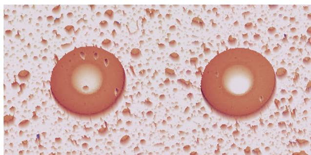
图 5. 使用 mFVU 观察到的双光纤的 3D 视图
