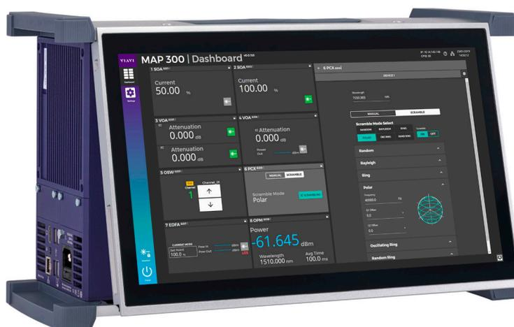
图 5 - 通过扩展坞连接了 15.6 英寸触摸屏的 MAP-330 台式主机，前视图
