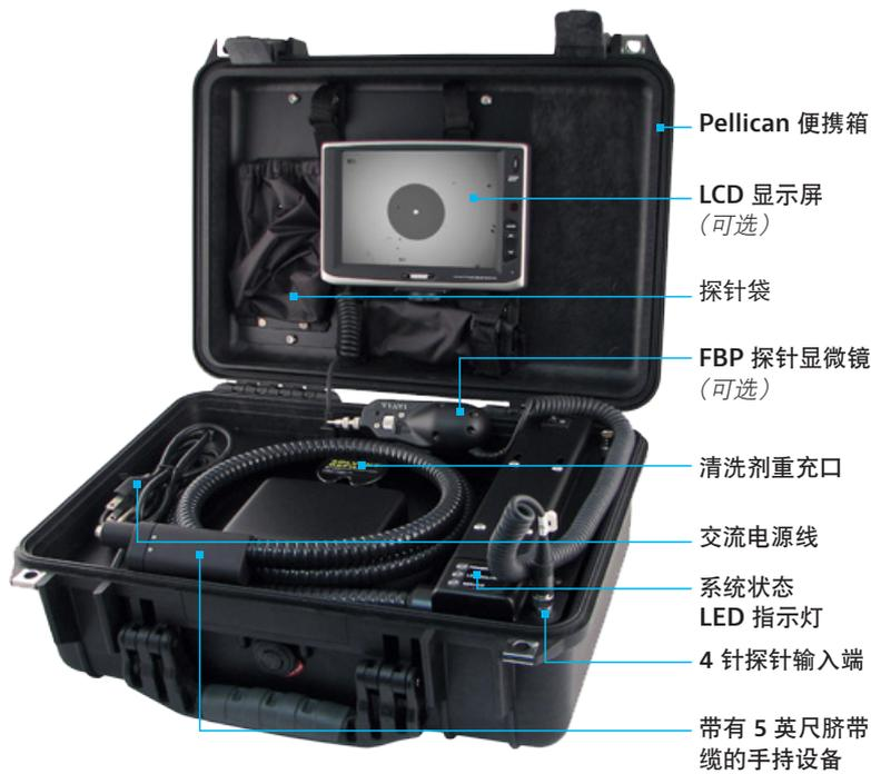
配备 FBP 探针和 LCD 的便携式 CleanBlast 系统
