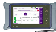
MTS-4000 V2 用于测试光纤网络的双槽位 手持式模块化平台
