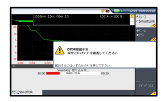
コネクタ・ケーブルの端面汚れまたは接続不良が考えられる 端面清掃・再接続の上、再測定を実施 2. テーブルにイベントが一つしか表示されない
