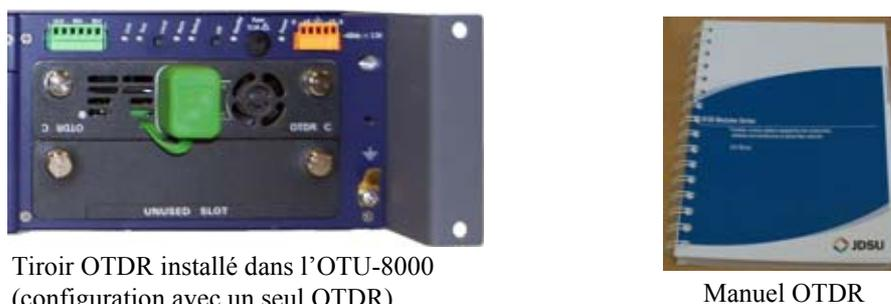
**Fig. 15** Module OTDR monté + Manuel Utilisateur
