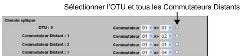
Fig. 70 Configuration Chemin optique
