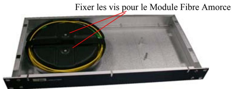
**Fig. 36** Installation de la Fibre Amorce
