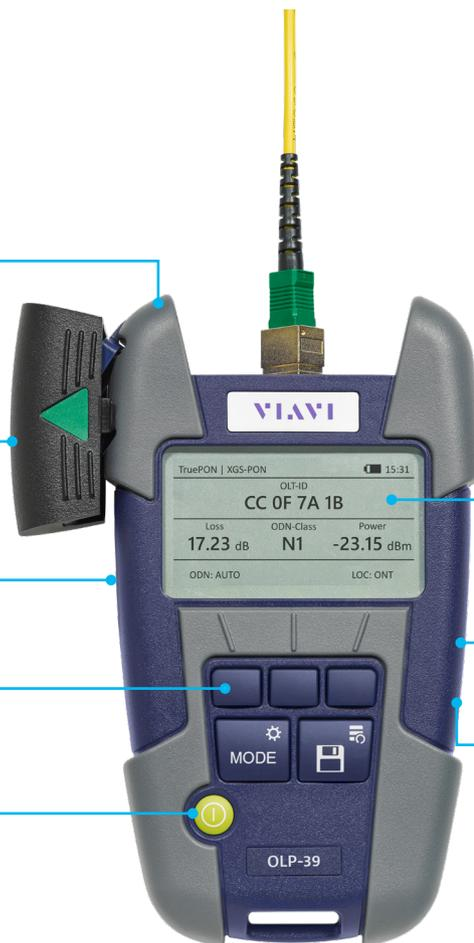
Novo display gráfico de alta visibilidade com retroiluminação
