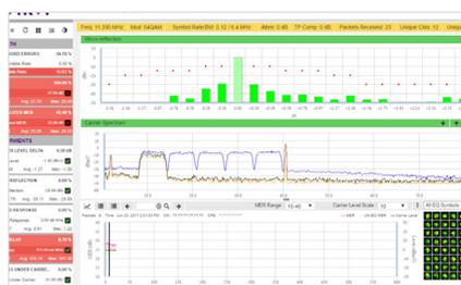
Display MACTrak em tempo real exibindo microrreflexões
