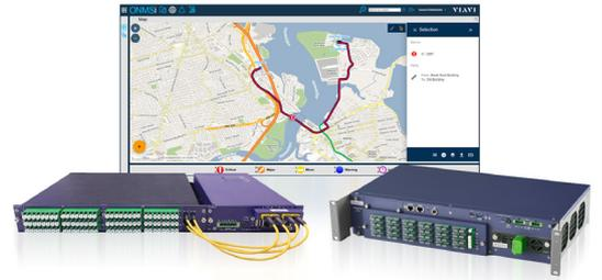
ネットワークの戦略的なポイントに配置された FTH は、光ファイバーインフラを恒久的にテストし、障害、潜在的なセキュリティ違反、またはセキュリティの脅威がファイバーインフラのレベルで検出されたときに、ONMSi 管理システムにアラームレポートを生成します。
