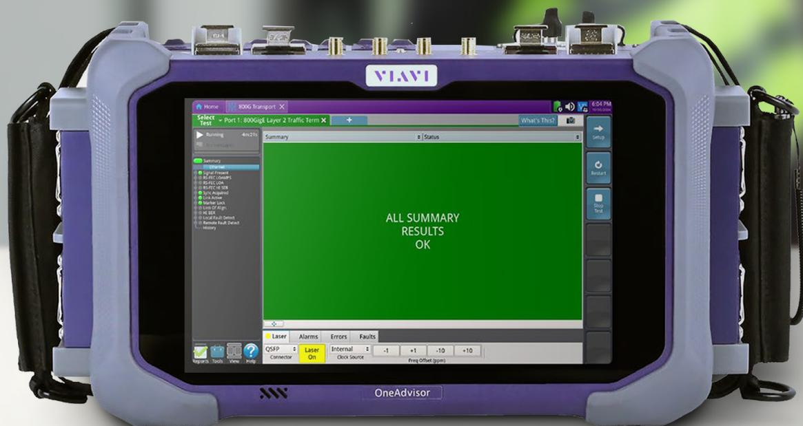
OneAdvisor 800 は、作業員やエンジニアが最大 800G の大容量ネットワークを敷設および保全するために必要なすべてのテスト機能を提供します。その携帯性とモジュール方式により、OneAdvisor 800 はメトロ/コア、データセンター相互接続、およびビジネスサービスのテストに最適です。OneAdvisor 800 用の 800G 輸送ポートモジュールは、最大 800GE のテストに対応し、MTS ファミリーのすべてと同じユーザーインターフェイスを備えています。
