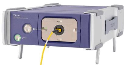
**mFVU-3000 FlexLight** デュアルオブジェクトブコネクターマイクروسコープは、照明の高度な柔軟性と全自動デュアルオブジェクトブ性能を提供し、正確で効率的な光インターフェイス検査を実現します。ラボ、製造、フィールド用途向けに設計されており、ネットワークパフォーマンスや製品の歩留まりに影響する汚れの問題に対処します。このシステムは、高倍率と低倍率用のデュアルオブジェクトブレンズでファイバーとフルフェルールのイメージングをサポートし、ケーラー同軸の 10 倍対物レンズとケーラー軸の 2 倍対物レンズ、角度調整、斜め照明機能を備えています。
