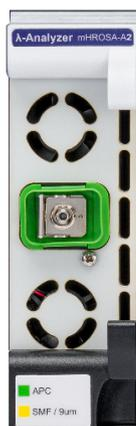
高分解能光スペクトラムアナライザ mHROSA-A2 は、サブ GHz の分解能パフォーマンスとコンパクトなモジュール性を1つのスロットカセットに組み合わせた高分解能光スペクトラムアナライザです。
