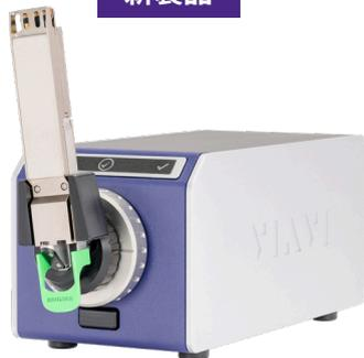
**FVAM-2000** アドバンストベンチトップ型マイクروسコープは、OSFP や QSFP などのデュアル MPO や次世代 VSFF コネクター用の高性能検査ソリューションで、800G/1.6T フォーマットに対応しています。バルクヘッドデバイス用のクイックチェンジインターフェースを提供し、高倍率かつ高解像度で端から端までファイバー端面を見ることができ、8 秒以内で詳細なマルチファイバー端面検査が可能です。FiberChekULTRA PC アプリにより、データ入力の簡素化、生産性の向上、IEC 準拠またはカスタムの合否判定をサポートします。そのオープンな REST API により、大量生産ワークフローへのシームレスな統合が可能です。
