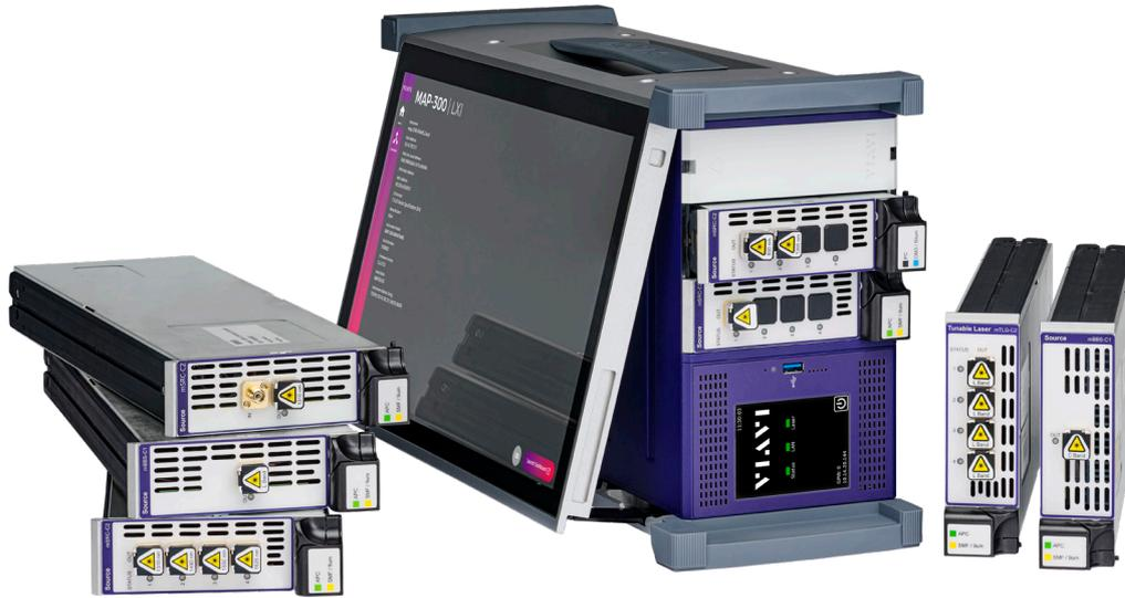
VIAVI マルチアプリケーションプラットフォーム (MAP) は、コスト効果の高い方法で光伝送ネットワーク要素を開発、製造できるように最適化された光テストおよび測定プラットフォームです。MAP メインフレームは、当社のモジュールポートフォリオ全体の基盤であり、光ネットワークエレメントの製造に拡張性と効率性をもたらします。カセットは積木式に使用できるユニットであり、テストごとのニーズを正確に満たすために LightTest ターンキーソリューションと設定変更が可能な LightDirectソリューションの2つの異なるファミリーに分類されます。
