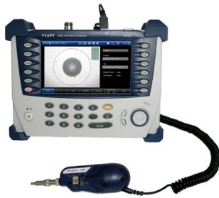
Analyseur de câbles et d'antennes CellAdvisor avec microscope P5000i
