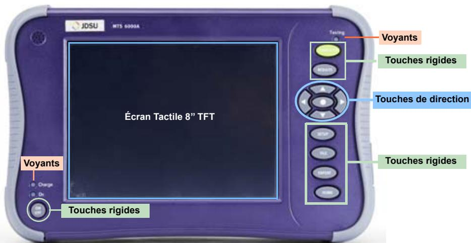
Fig. 3 Plate-forme 6000A V2 - Description face avant
