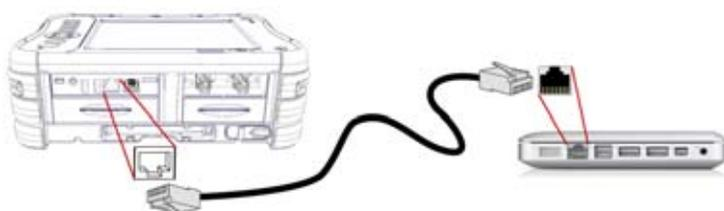
Fig. 35 Connexion Plate-forme 6000A V2 <-> PC
