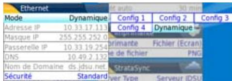
Fig. 37 Exemple de configuration pour Ethernet
