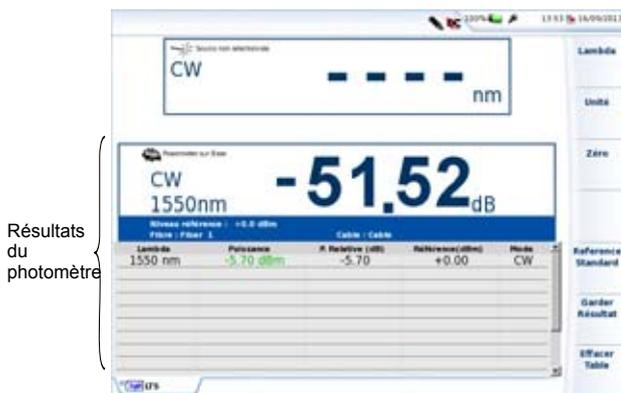
**Fig. 12** Résultats et commandes du photomètre
