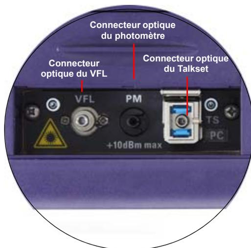
Fig. 10 Connecteurs optiques
