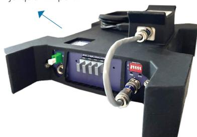
avec **module de connexion à distance** avec câble USB pour la connexion au module OTDR 4100 et avec câble RS485 pour la connexion au commutateur (inclus)
