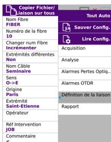
**Nom Fibre** Sélectionner le paramètre **Nom Fibre** et saisir un identifiant pour la fibre en utilisant le clavier à l’écran.
