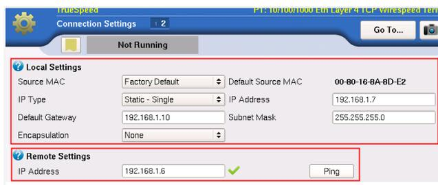
Figura 3. Configuración de dirección IP
