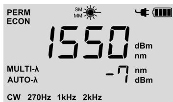
Fig. 2 Pantalla del OLS-34/-35 (con todos los elementos correspondientes)
