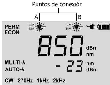
Fig. 3 Pantalla del OLS-36 (con todos los elementos correspondientes)
