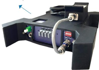
con un **módulo de conexión remota** que cuenta con cable USB para conectarse al módulo 4100 OTDR y con un cable RS485 para conectarse a la unidad de conmutador (incluido)
