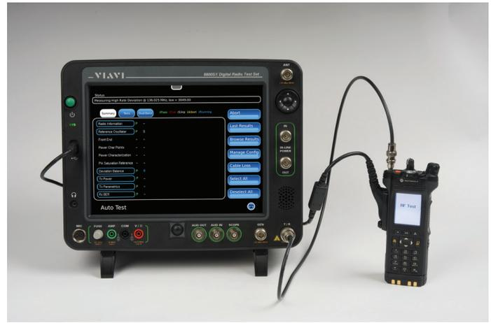
Configuración de las pruebas automáticas del sistema 8800SX
