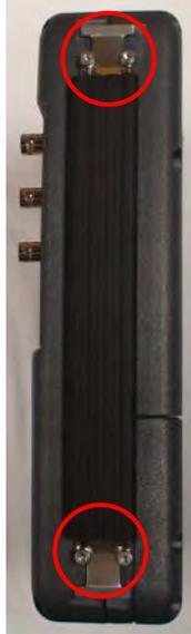
2. Coloque ambos protectores (a la derecha e izquierda del equipo) y ajuste los tornillos de sujeción a cada lado del protector (a una presión de 8 libras por pulgada).
