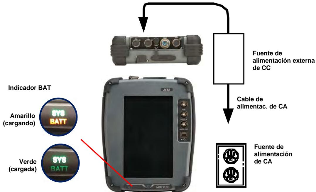
1. Conecte la fuente de alimentación externa de CC al conector de entrada de CC en las unidades 3550 / 3550R.
