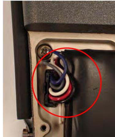
2. Coloque la cubierta de la batería en el equipo y ajuste los cinco tornillos de sujeción (a una presión de 8 libras por pulgada).
