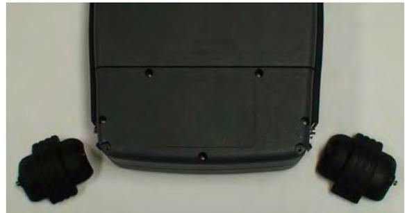
2. Afloje completamente los cinco tornillos de sujeción de la cubierta de la batería y levante la cubierta.
