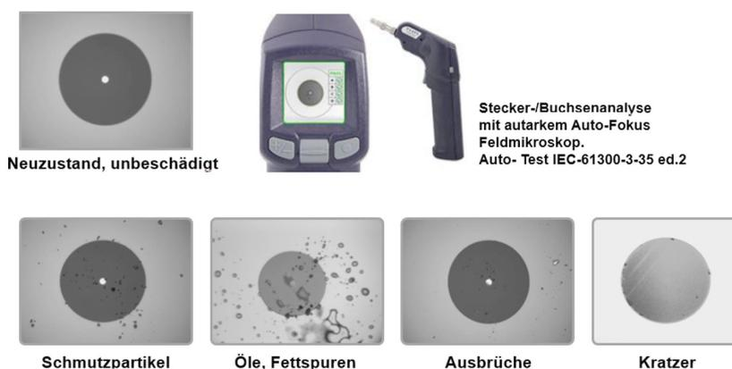
Bild 8 Typische Störungsbilder von Glasfaser Steckern (gemessen und bewertet mit normgerechten Fasermikroskop)
