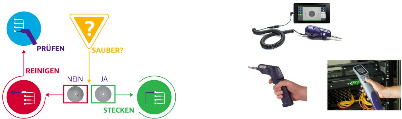
Eingesetzte Messtechnik: VIAVI P-5000i, FC-Probe, Sidewinder
