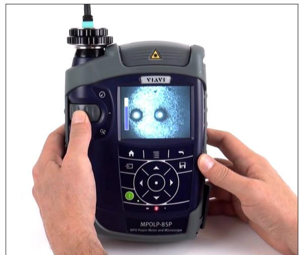
MPO-Mehrfaserverbinderprüfung mit integriertem Patchkabel-Mikroskop (PCM)
