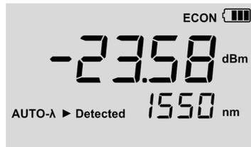
Abb. 4 Anzeige des Absolutpegels in dBm.
