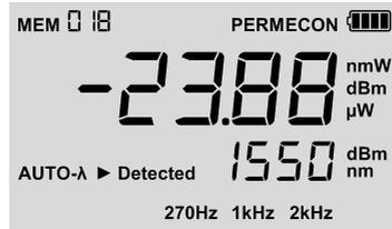
Abb. 2 Messanzeige (mit allen Anzeigeelementen)
