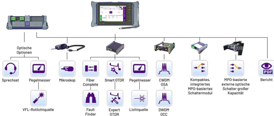
Das MTS-4000 V2 ist eine hochgradig integrierte optische Testplattform mit zwei Modulsteckplätzen und einem 9 Zoll (23 cm) großen farbigen Multi-Touchscreen, die zahlreiche optische Testfunktionen zur Verfügung stellt.
