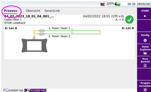
Im oberen Teil des Fensters wird der Messaufbau mit der Kennung der einzelnen Komponenten (Name der Position und des Schleifenkabels, die Fasernummern...) angezeigt.
