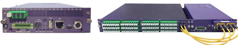
FTH-Testköpfe zur Überwachung von Dark-Fiber- und Lit-Fiber-Strecken
