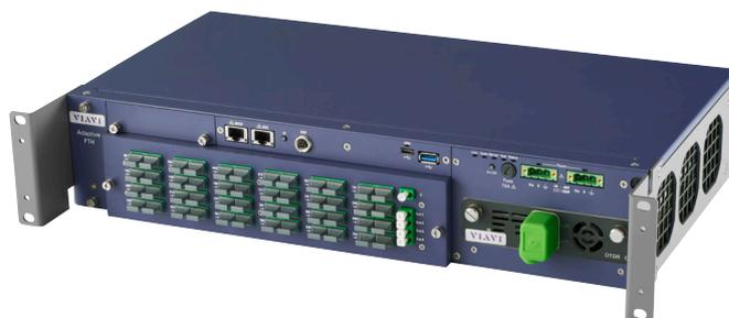
FTH-9000 mit dem 576 MPO-Schalter mit OTDR-Modul
